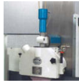
Automatyczny liniowy obciągacz diamentowy Bermi na głowicy
