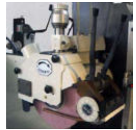
Narzędzie do nagniatania ściernic "Bermi" z 2 suwakami
