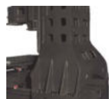
Wzmocnione żebrowane żeliwo
