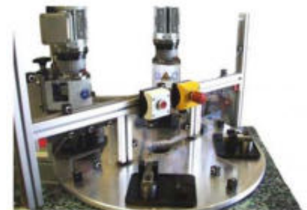
Nitownica obrotowa do mocowania zacisków na kondensatorze za pomocą dwóch nitownic promieniowych RN 081
