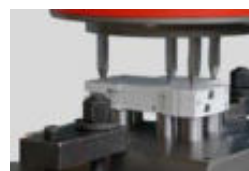
Nitownica obrotowa do mocowania zacisków na kondensatorze za pomocą dwóch nitownic promieniowych RN 081
