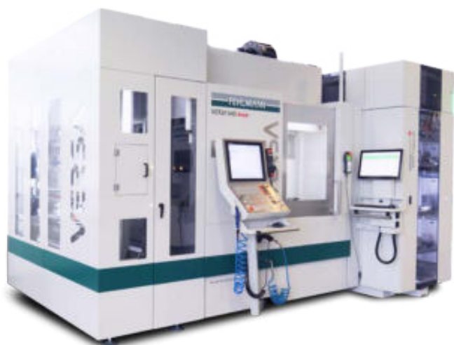
VERSA 645 linear z systemem załadunku detali Eropa Robot Compact na palety i magazynem regałowym na 250 narzędzi (po lewej). Dostępne różne rozmiary rozszerzonych magazynów.
