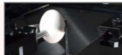
imadło do detali cienkościennych system mocowania może nawet zaciśnąć jajko!
