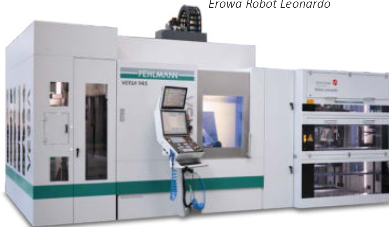
VERSA 945 z systemem obsługi palet Eropa Robot Leonardo
