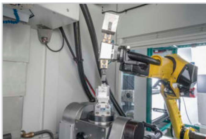
PICOMAX 75 z modułowym 6-osiowym ramieniem przegubowym do przenoszenia półproduktów.
