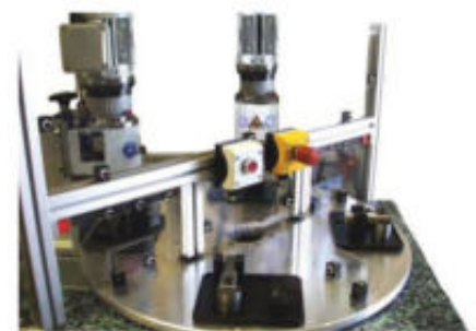
Rotační nýtovací stanice pro zajištění svorek na kondenzátoru pomocí dvou radiálních nýtovacích strojů RN 081
