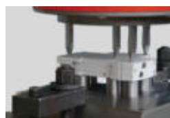
Rotační nýtovací stanice pro zajištění svorek na kondenzátoru pomocí dvou radiálních nýtovacích strojů RN 081
