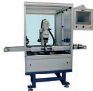
CNC-Koordinaten-Nietmaschine mit Transfersystem zur Integration in Transferlinie
