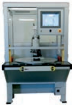
CNC-Koordinaten-Nietmaschine mit Rundschalttisch als kompletter, autonomer Arbeitsplatz
