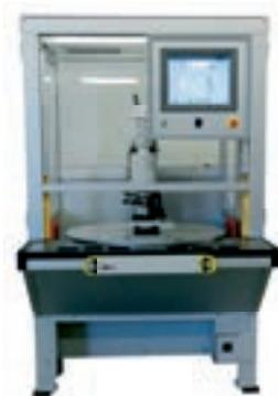
Координатно-клепальная машина с ЧПУ с поворотным столом, комплектное автономное рабочее место
