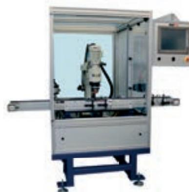
Координатно-клепальная машина с ЧПУ для встраивания в автоматическую линию
