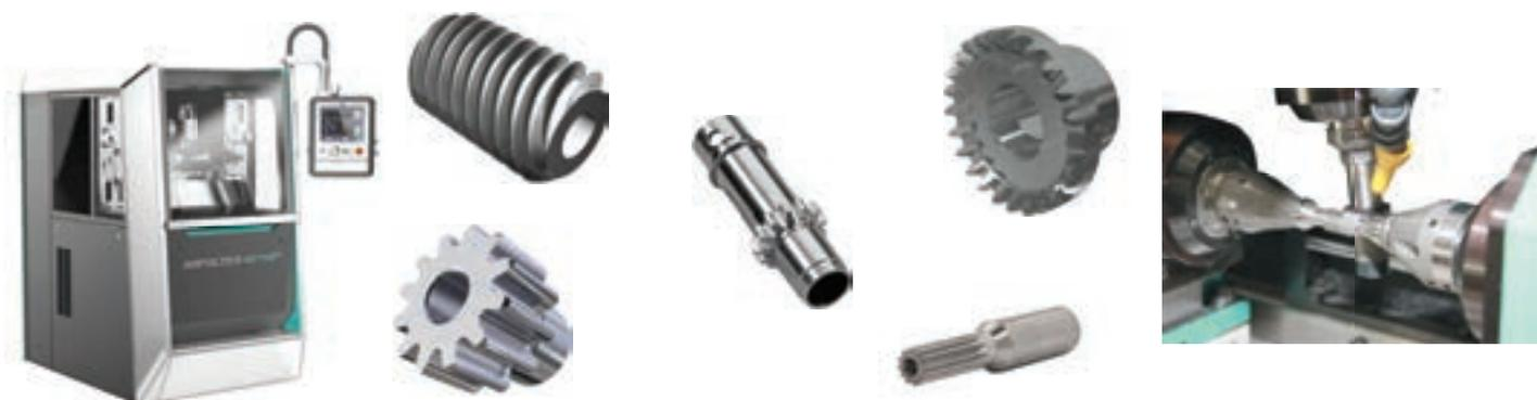
Прецизионный зубофрезерный центр высокой жесткости с мощным шпинделем, с автоматизацией и без автоматизации
