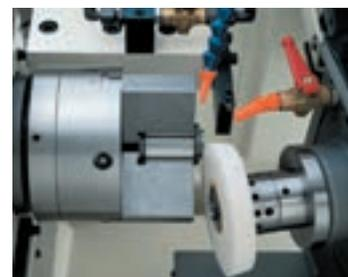
VOUMARD VM 110 является универсальным станком для внутреннего и наружного круглого шлифования как для единичного, так и серийного производства деталей небольших размеров.
