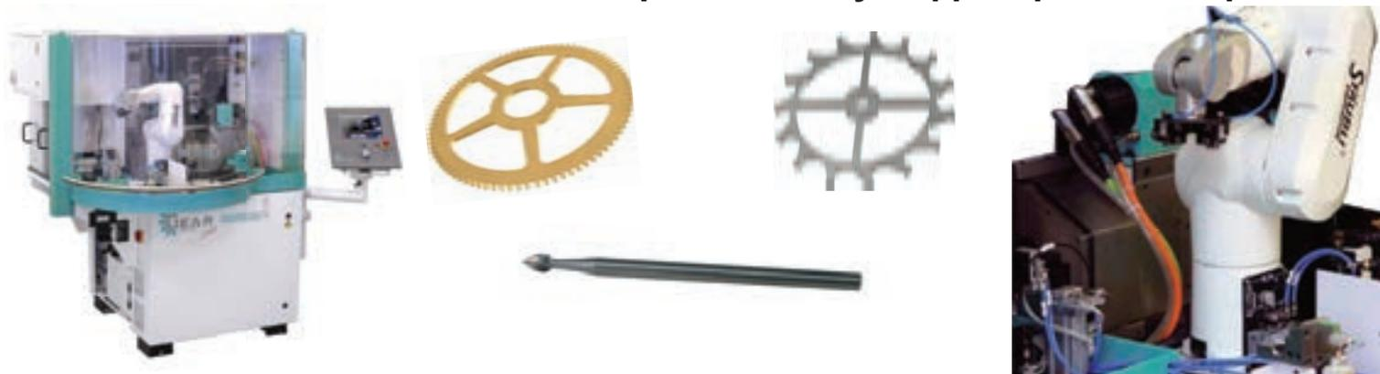
Зубофрезерный центр с роботом-загрузчиком и различными системами подачи заготовок: паллеты, ленточные накопители и т.п.
