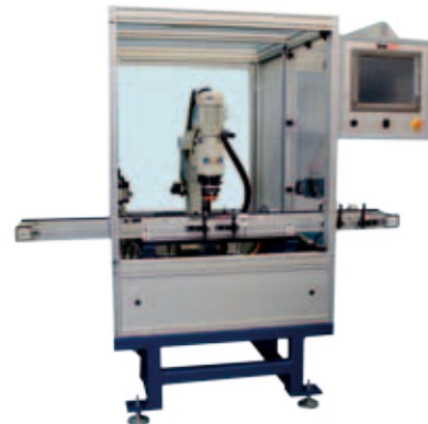
CNC-koordináta-szegecselőgép transzfer rendszerrel, gyártósorba integráláshoz
