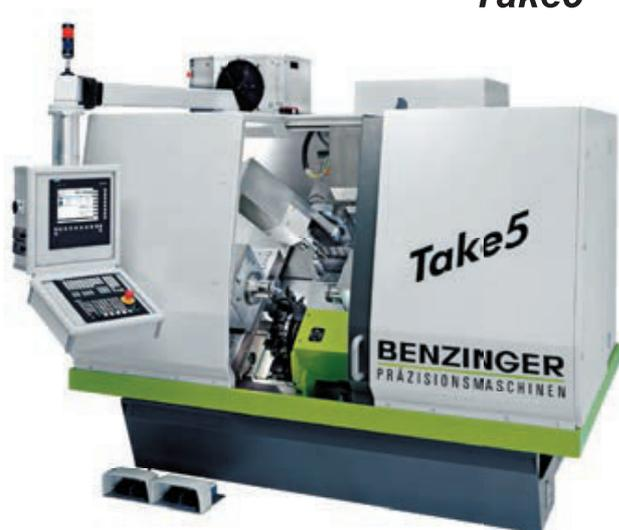
Svislá revolverová hlava VDI25 se 16 nástrojovými pozicemi, každá pozice vždy se samostatným pohonem.
