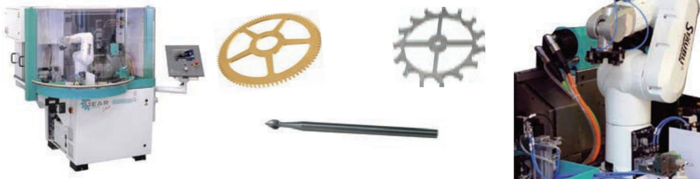
Centrum na výrobu ozubení s automatickým robotem, rozpoznáváním obrazu a různými podávacími systémy, jako je paletizační systém, dopravníkový buben, pásový dopravník, atd.
