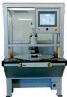
CNC souřadnicový nýtovací stroj s kruhovým otočným stolem jako kompletní samostatné pracoviště
