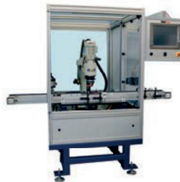
CNC souřadnicový nýtovací stroj k zástavbě do automatické linky
