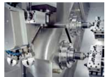
Ausbaustufe B5: 2-spindlig mit Schwenklader für kürzeste Werkstückwechselzeiten, Werkzeugaufbau linear
