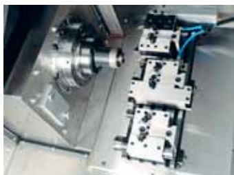
Ausbaustufe B1: optional mit NC-Schwenklader für kürzeste Werkstückwechselzeiten, Werkzeugaufbau linear, optional mit Schleifspindel
