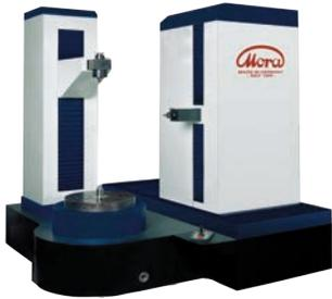
X-, Y- und Z-Präzisionsführungen aus Hartgestein, luftgelagert, Luftdämpfungssystem, Scantaster Vermessung von Stirnrädern gerade-, schräg- od. innenverzahnt, Schneckenrad, etc. Auswertmöglichkeit nach DIN, ISO, AGMA oder freier Toleranz. Universelle und bedienerfreundliche Zahnradsoftware AC-Gear
