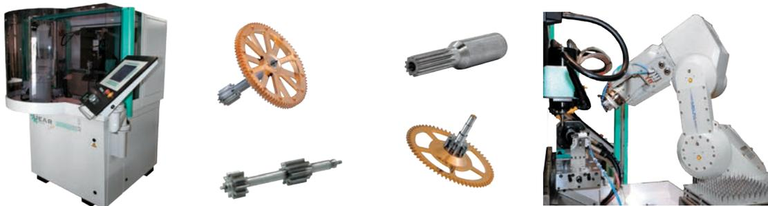
Verzahncenter mit Roboter-Automation und diversen Zuführsystemen wie Palettisiersystem, Fördertopf, Förderband, Bilderkennung etc.
