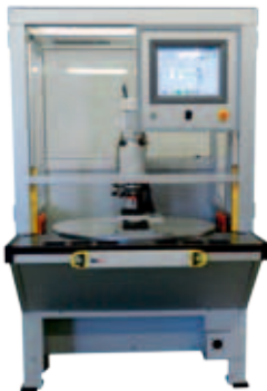
CNC-Koordinaten-Nietmaschine mit Rundschalttisch als kompletter, autonomer Arbeitsplatz
