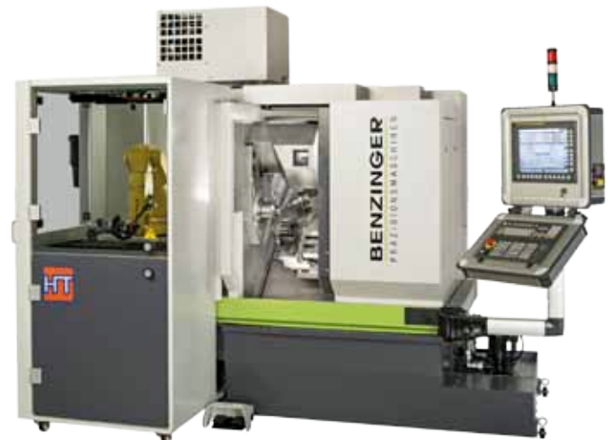
2 Arbeitsspindeln mit C-Achse, 2 Revolver VDI 25 mit 12 oder 16 Werkzeugplätzen, jeder mit Einzelplatzantrieb, Y-Achse für beide Spindeln, Revolver 1 und Gegenspindel auf separatem Kreuzschlitten, Revolver 2 stationär, simultane Komplettbearbeitung
