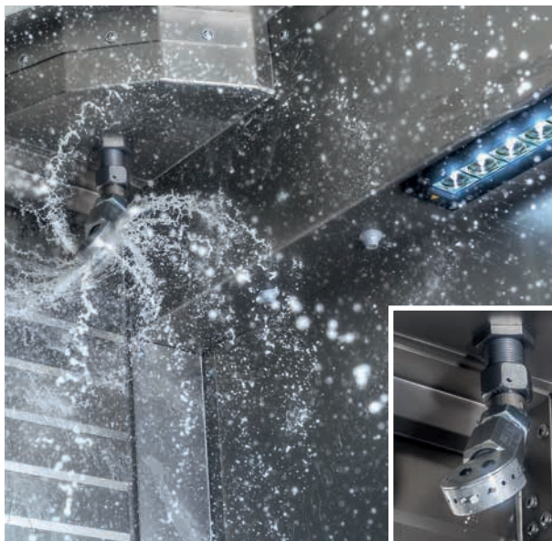
Arbeitsraumpülung und Beleuchtung
