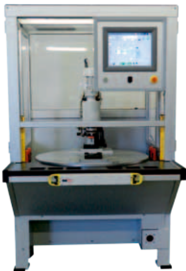
CNC-Koordinaten-Nietmaschine mit Rundschalttisch als kompletter, autonomer Arbeitsplatz
